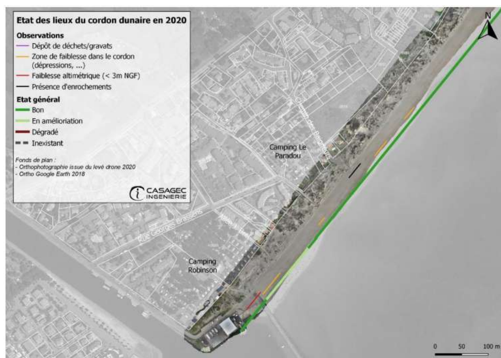
Figure 7: Carte de l'état des lieux du cordon dunaire en 2020 sur le secteur sud de la zone nord. (Source: Rapport N°CI-19078 - REV00)
